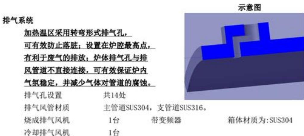
图 5-6 “L”型炉膛排气系统示意图
