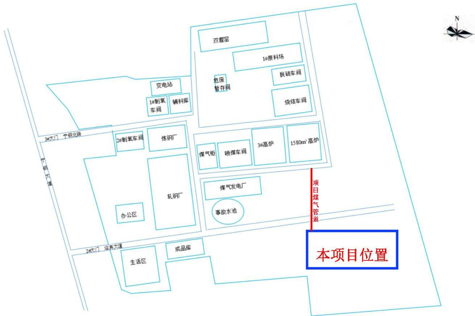
图6 项目煤气管道分布图
