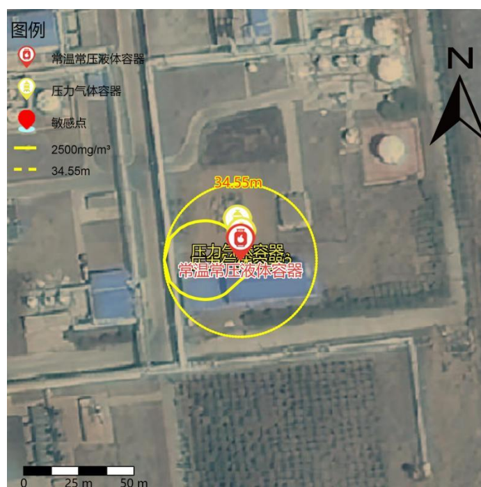
图 6.6-1 事故发生后 30min 二甲基硫醚扩散范围
