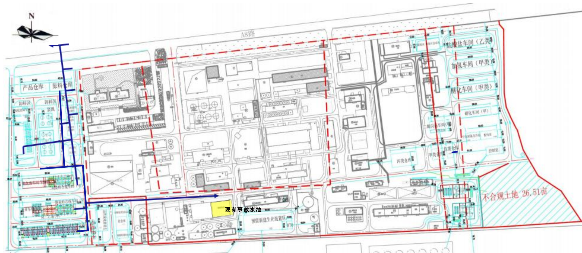
图 8.7-5 本项目防止事故水进入外环境的控制、封堵系统图
