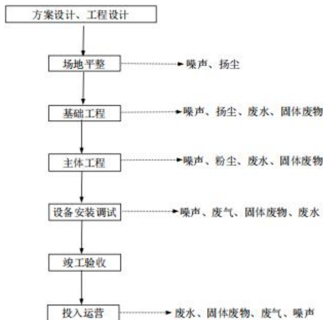
图 2-4 本项目施工工艺流程及产污环节图
