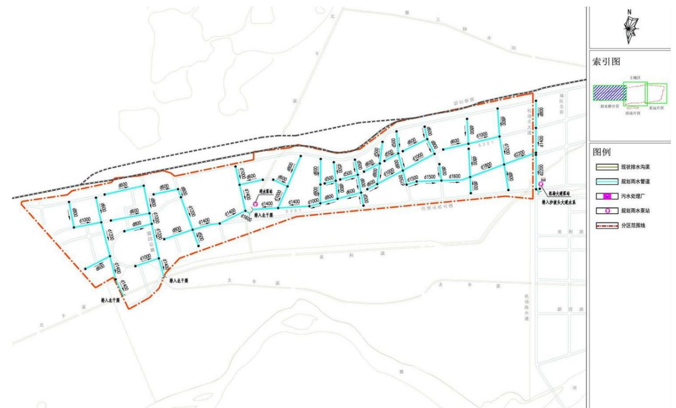
图 6-4 迎水桥片区雨水管道规划平面图
