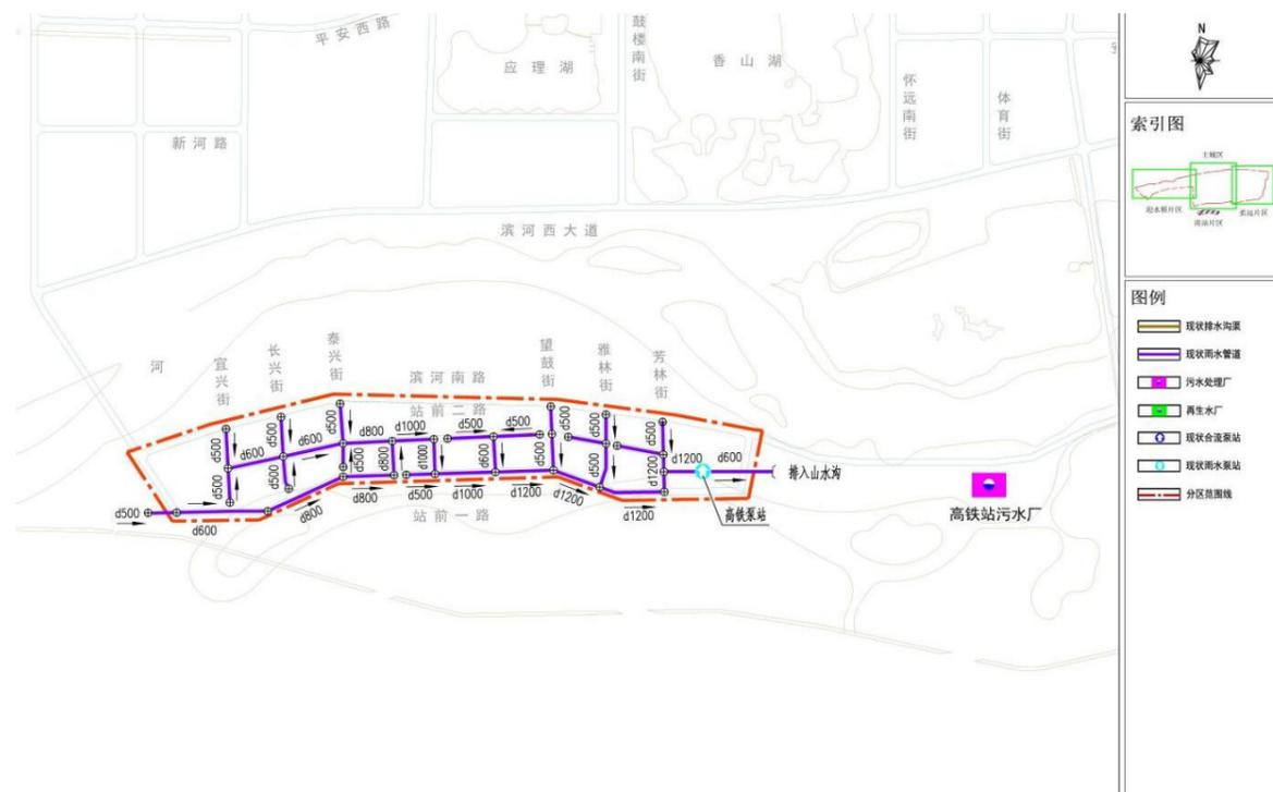
图 3-8 南站片区雨水管道现状平面图
