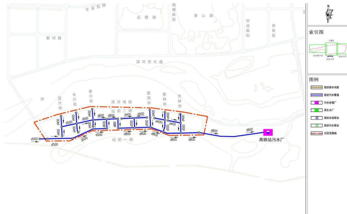
图 3-7 南站片区污水管道现状平面图
