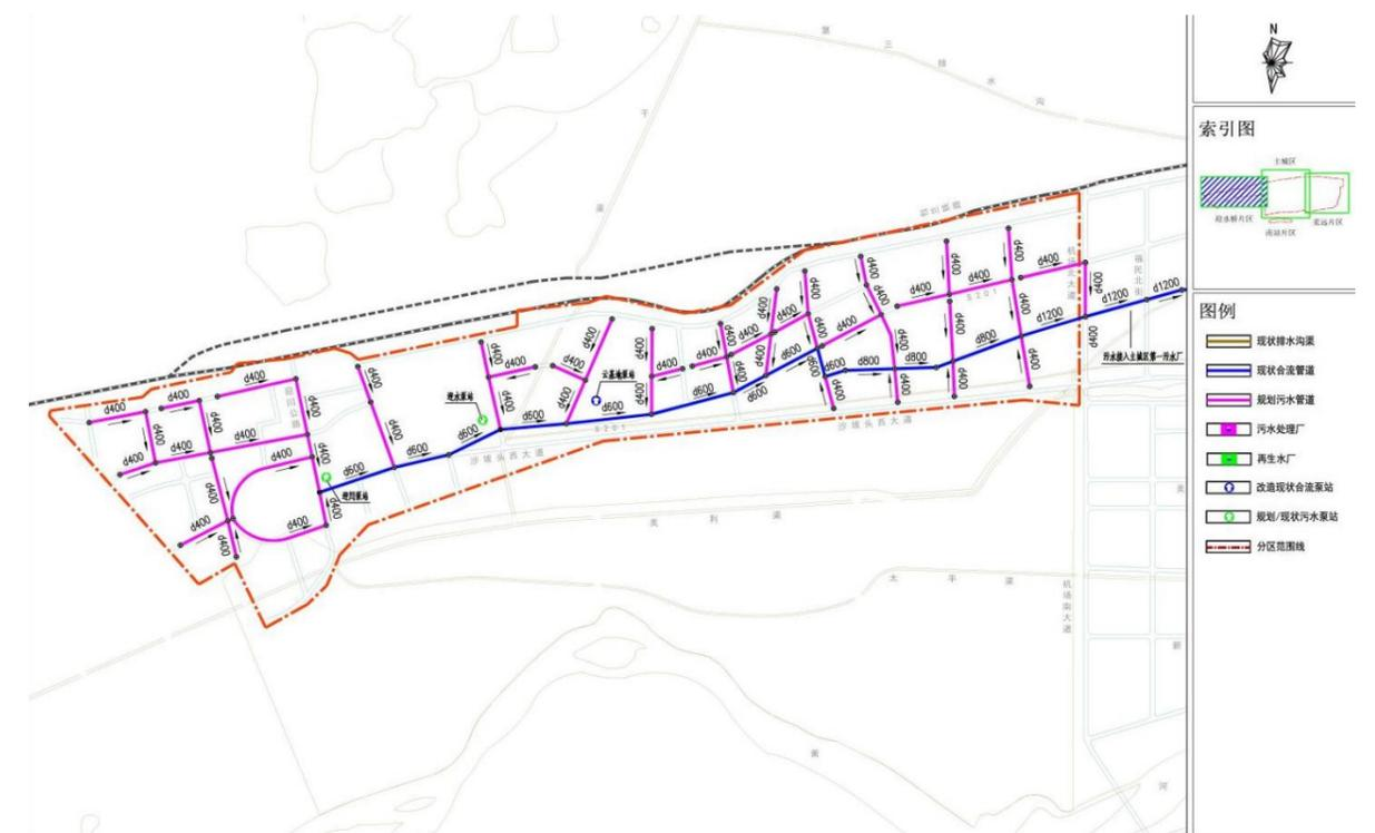
图 5-4 迎水桥片区污水管道规划平面图
