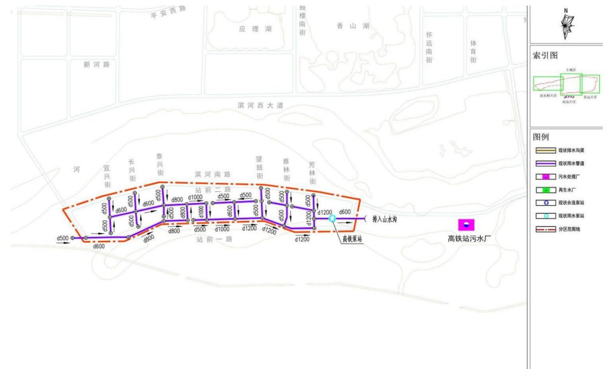
图 6-5 南站片区雨水管道规划平面图
