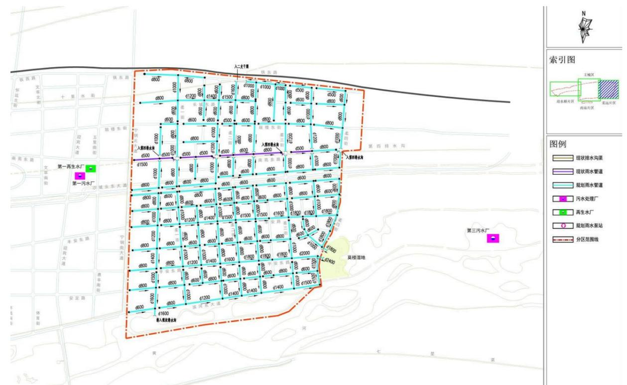
图 6-3 柔远片区雨水管道规划平面图
